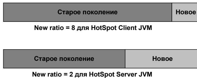
Рис. 4.17. Относительные размеры пулов младшего и старшего поколения в разных версиях HotSpot JVM
