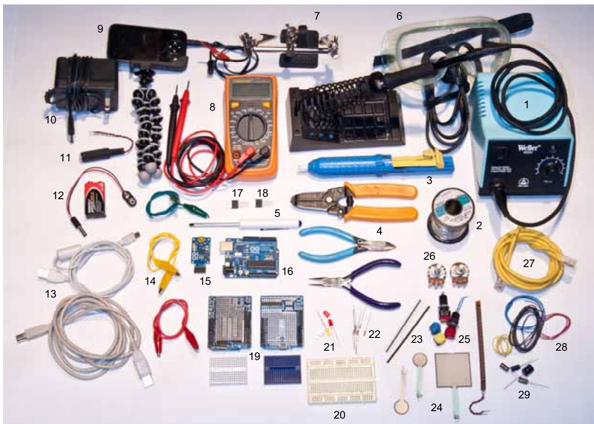
Рис. 1.1. Инструменты и детали, используемые в проектах этой книги. Их краткое описание дается далее
