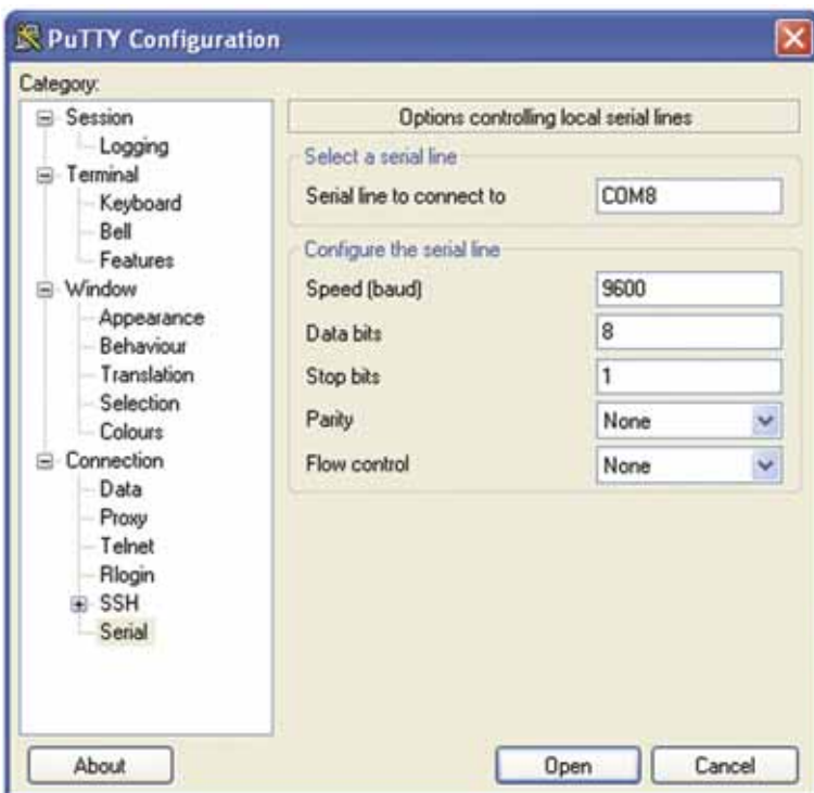
Рис. 1.6, б. Настройка параметров последовательного соединения
