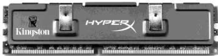
Рис. 1.30. Модуль оперативной памяти (с радиатором охлаждения микросхем)
