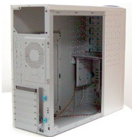
Рис. 1.7. Отсеки под трех- и пятидюймовые устройства
