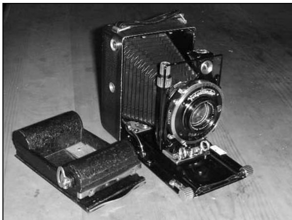
Рис. В3. Пленочная камера с размером кадра 5×7 см (середина XX века)
