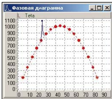
Рис. 1.7. Пример графика, в который, возможно, вкралась вычислительная ошибка
